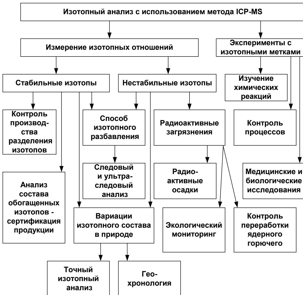
Рис. 1.1. Основные области применения метода масс-спектрометрии с индуктивно связанной плазмой (ICP-MS) для изотопного анализа
